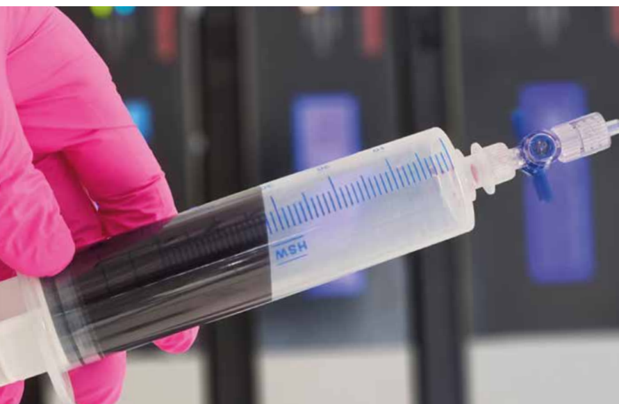
Sulfiquant: mesure de la concentration de SO 2 libre dans un vin via l'espace de tête.
