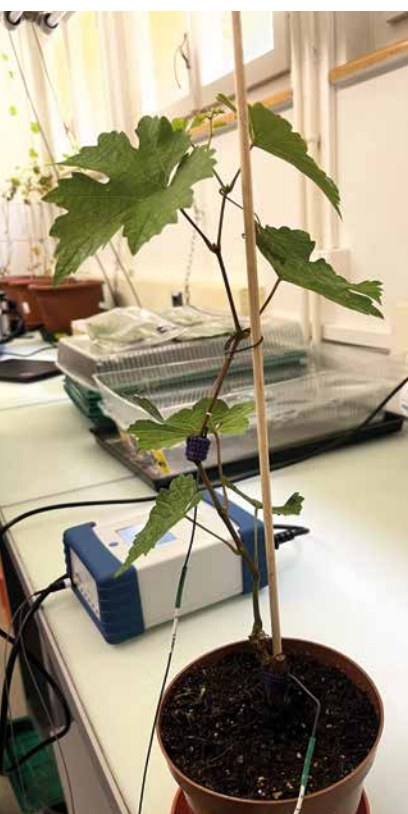
Des capteurs permettent de mesurer l'électrophysiologie de la vigne, en réponse au stress hydrique dans le cadre du projet Agrarsense
